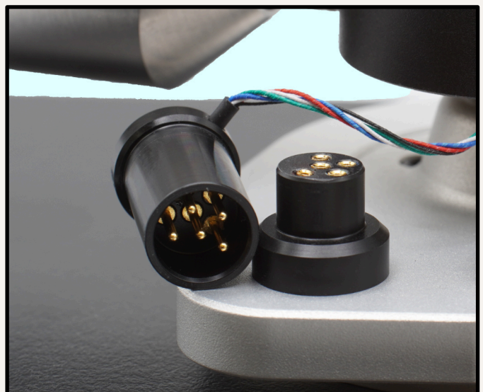
Figure–33: Miniature special DIN plug
